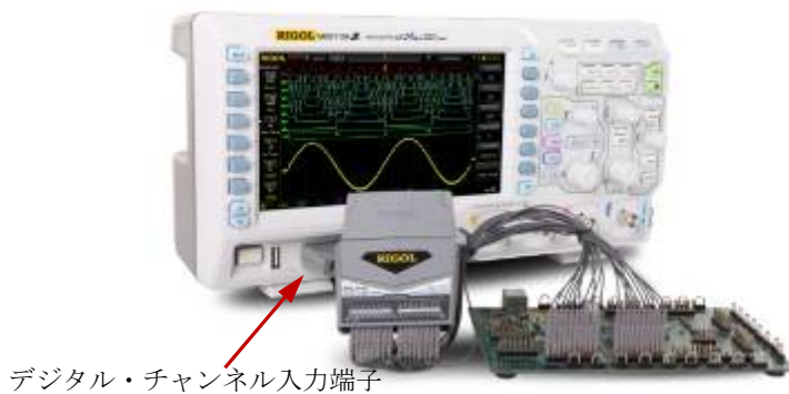
図 1-6 ロジック・プローブの接続
